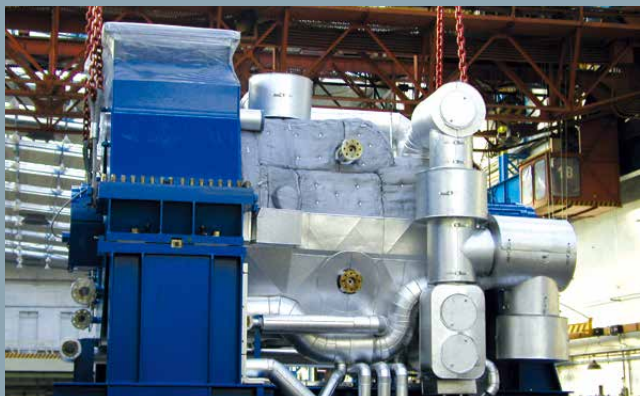
SST-400，加拿大英属哥伦比亚省本拿比；25MW。 垃圾焚烧电厂的抽汽凝汽式汽轮机
