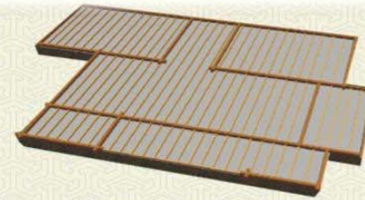
基础龙骨与横梁铺设
