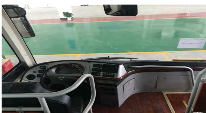
C2.4.2-1 前中门区域内饰含铝合金天花板，彩粒石英砂地板，坐椅，LED 灯具，不锈钢扶手，防紫外线玻璃，车窗。遵循 ECE/TS16949 标准。零部件适用标准 CNAS
