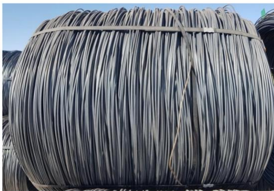
Bobina com 1 espira grande "repuxada".
