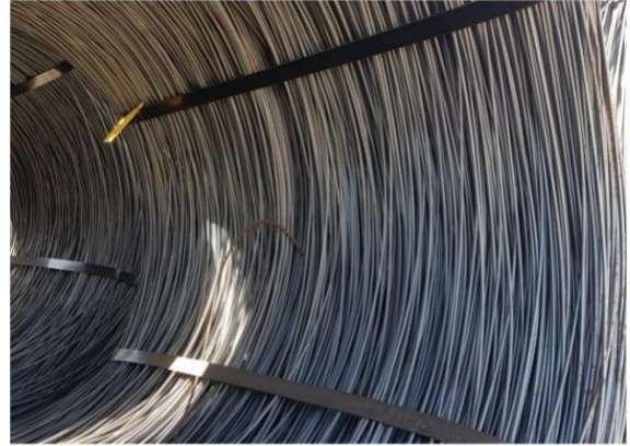
Bobina com espiras "repuxadas/amassadas" no interior.
