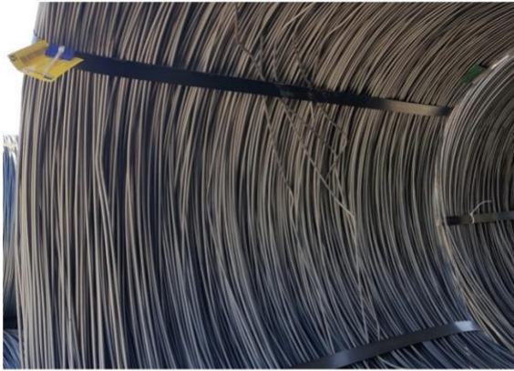
Bobina com espiras "repuxadas/amassadas" no interior.
