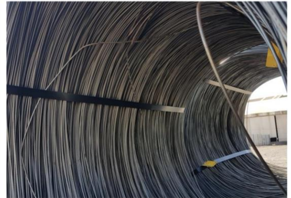
Bobina com espiras "repuxadas/amassadas" no interior.
