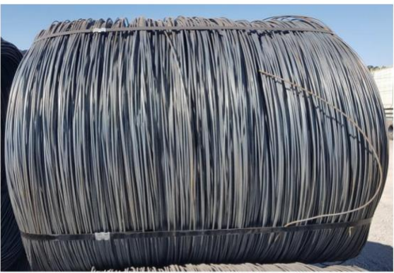
Bobina com 1 espira grande "repuxada".
