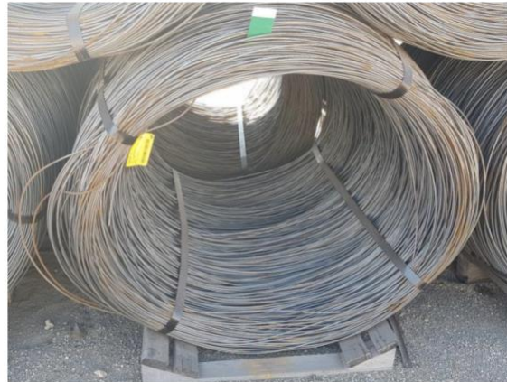
Bobina com espiras grandes na lateral "repuxadas".
