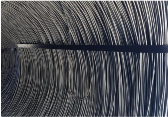
Bobina com espiras "repuxadas/amassadas" no interior.
