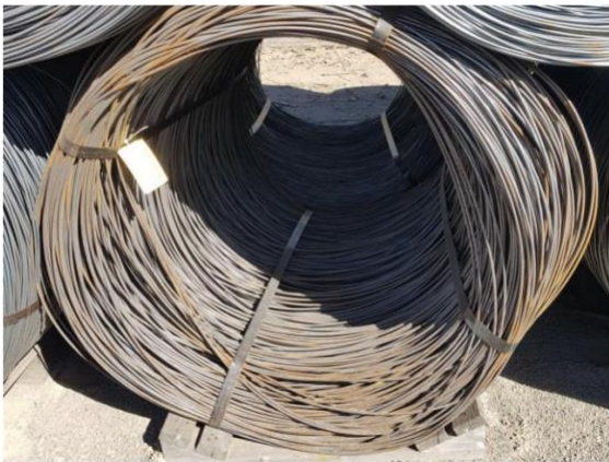
Bobina com espiras grandes na lateral "repuxadas".
